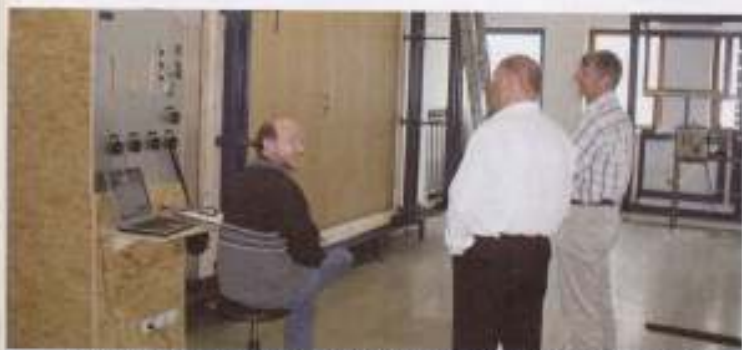
Die Tests werden persönlich überwacht: hier beim Schlagregentest. Den Messinstrumenten entgeht nichts: Messung der Durchbiegung bei Windlast.
