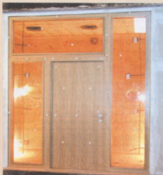
Prüfung einer Rubner Brandschutz Tür am IBS in Linz
