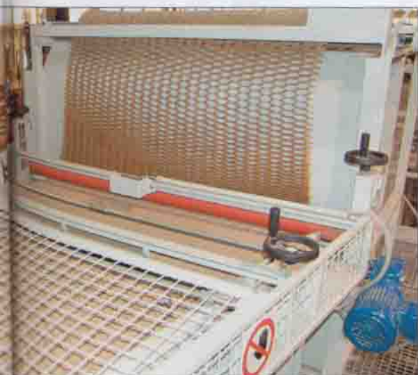
Papierwabeneinlagen werden durch einen Expandierofen aktuell und formatensprechend erzeugt, hier die Einlaufzohne
